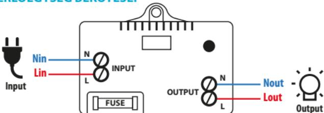
Az „INPUT” felirattal ellátott aljazatokhoz csatlakoztassa a feszültségmentesített hálózati vezetéket.
