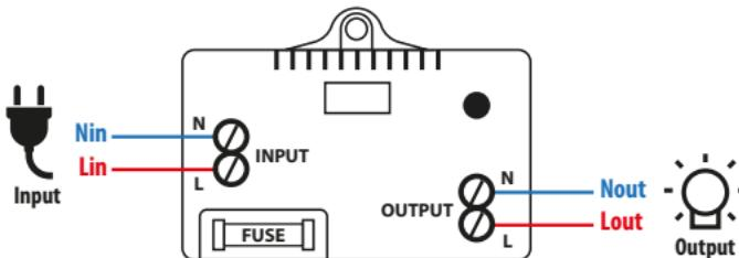
Odpojený sietový kábel zapojte do zásuviek označených „INPUT“.
