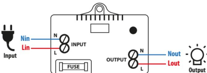
Odpojený sítový kabel zapojte do zásuvek označených „INPUT“.
